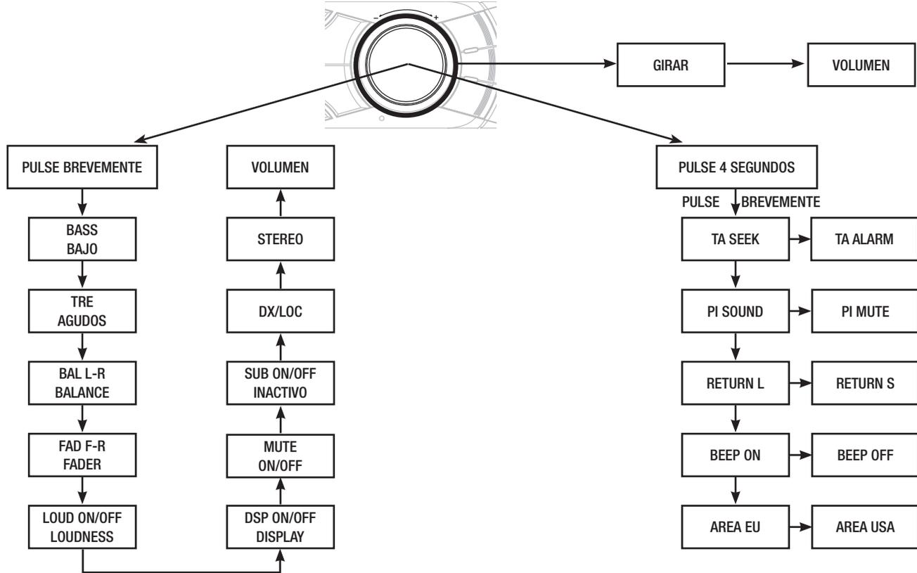
El ajuste se realiza girando el mando en sentido horario o en sentido contrario. Pulse brevemente para ajustar la siguiente función. Espere unos segundos para volver a la función anterior.
