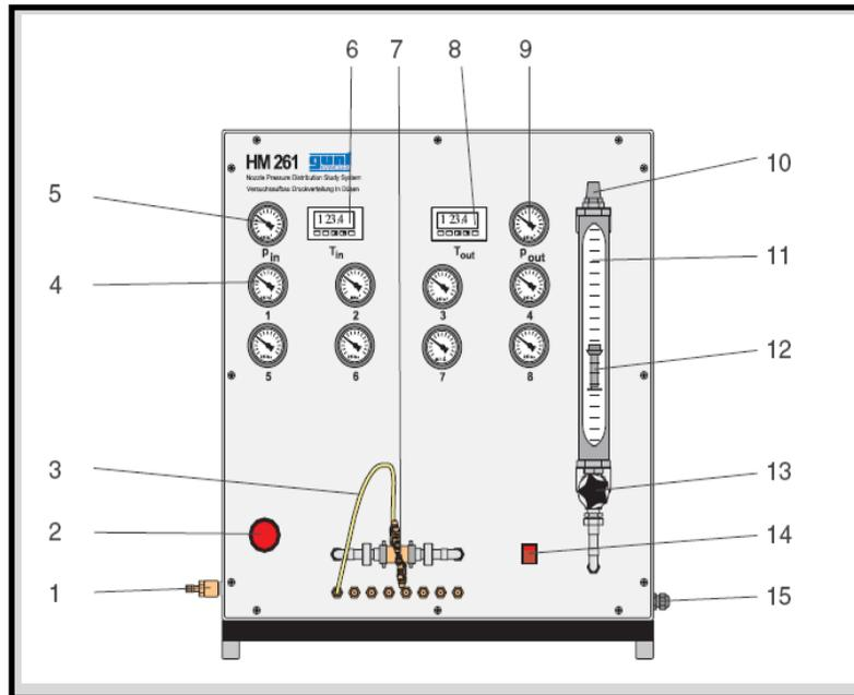
1 Conexión aire comprimido, 2 Regulador de la presión de entrada, 3 Mangueras flexible para el control de presión en las diferentes secciones, 4 Manómetros, presión en cada sección, 5 Presión a la entrada, 6 Temperatura a la entrada, 7 Inyector de experimento, 8 Temperatura a la salida, 9 Presión a la salida, 10 Silenciador, 11 Medidor de flujo, 12 Partículas en suspensión, 13 Regulador de presión de salida, 14 Interruptor, 15 Alimentación
