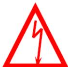
El símbolo del rayo con punta de flecha, dentro de un triángulo equilátero, es para alertar al usuario sobre la presencia de “voltage peligroso” no aislado dentro del gabinete del producto que puede ser de suficiente magnitud para constituir un riesgo de descarga eléctrica a la personas.
