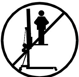
**3.1** - El elevador TL-070 es una máquina diseñada para la elevación de cargas en sentido vertical, NUNCA se debe utilizar como plataforma elevadora de personas.
