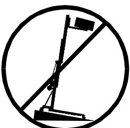
**3.2** - Colocar el elevador sólo en superficies duras y planas, verificando que está en posición vertical, mediante el nivel de burbuja (**F**) situado en el tramo base. Ajustar si fuera necesario con los platillos de apoyo (**Q**), girando la manivela (**H**) en el sentido adecuado. Nunca utilice cuñas ni elementos extraños para equilibrar el elevador.
