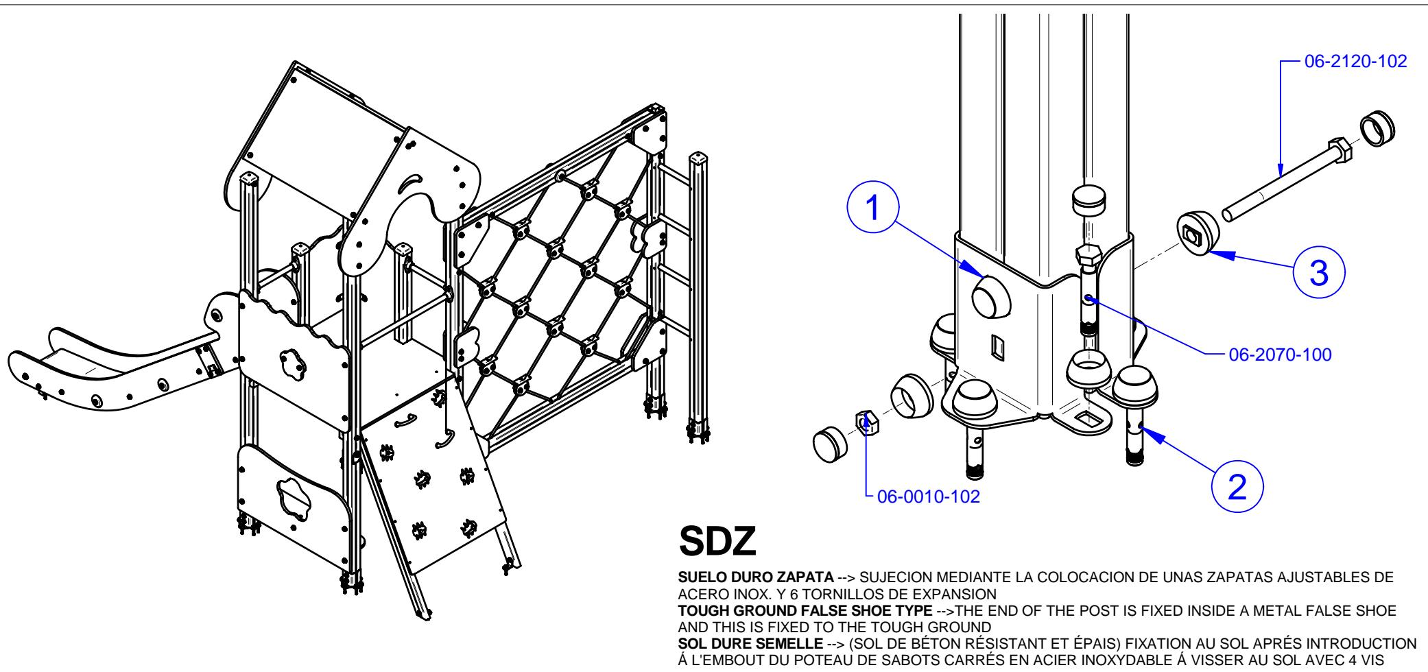
Detalles de la cimentación necesaria en condiciones normales (debería tenerse cuidado en lo referente a las condiciones anormales).
