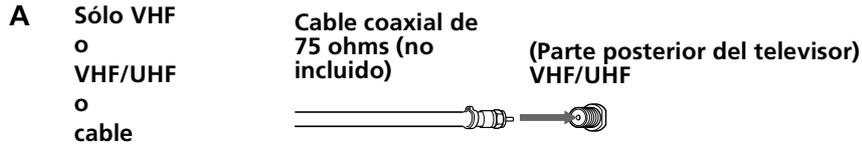
Utilice la opción A cuando el televisor esté conectado ya sea al decodificador o a la antena con un cable de 75 ohms.
