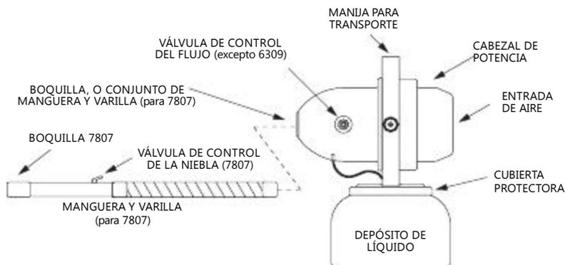
La máquina tiene un depósito de 4 litros para el líquido que se utilizará para la niebla. En el 7807, la boquilla de atomización está en el extremo del conjunto de manguera/varilla; en otros modelos, a excepción del 7807, está montada en el cabezal de potencia.
