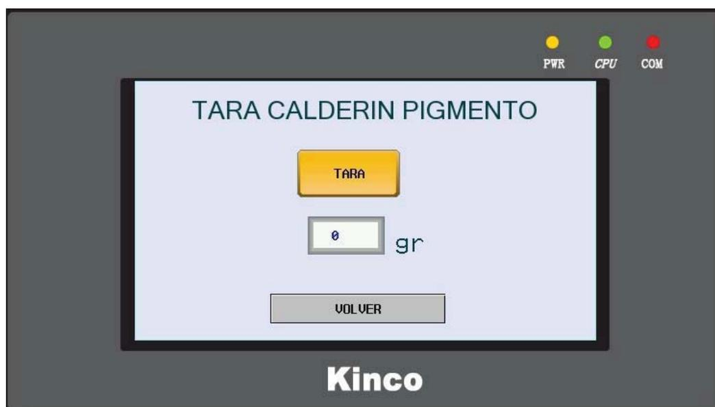
En esta pantalla tararemos el **calderín pigmento (D)**, para ello pondremos sobre la **báscula calderín pigmento (23)** el **calderín pigmento (D)** en vacío y con sus mangueras conectadas, pulsamos sobre **TARA** y se nos mostrará debajo el peso del calderín.
