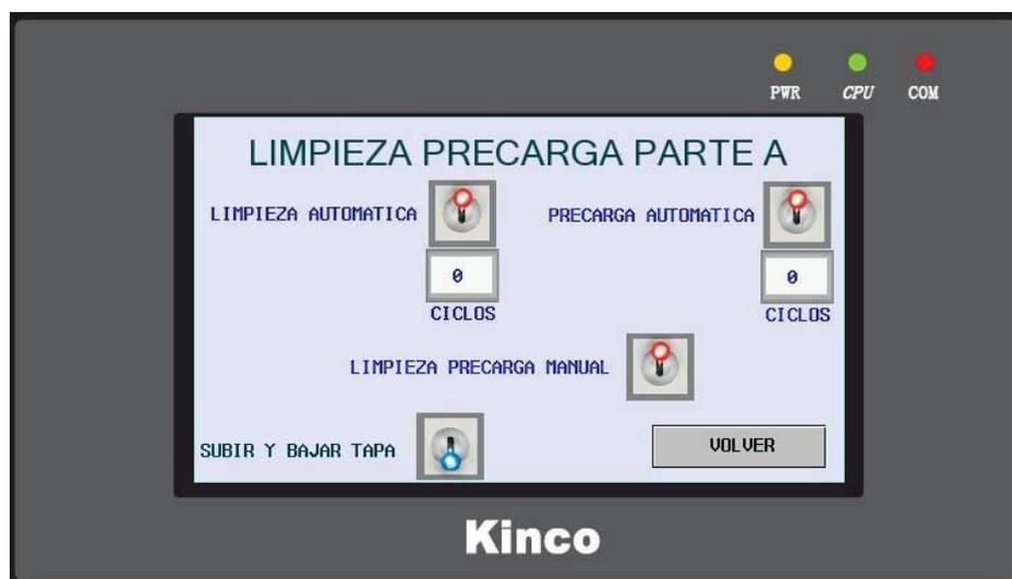
En esta pantalla se nos permite limpiar la bomba de producto de la **parte A** de dos formas, de forma automática de forma manual.
