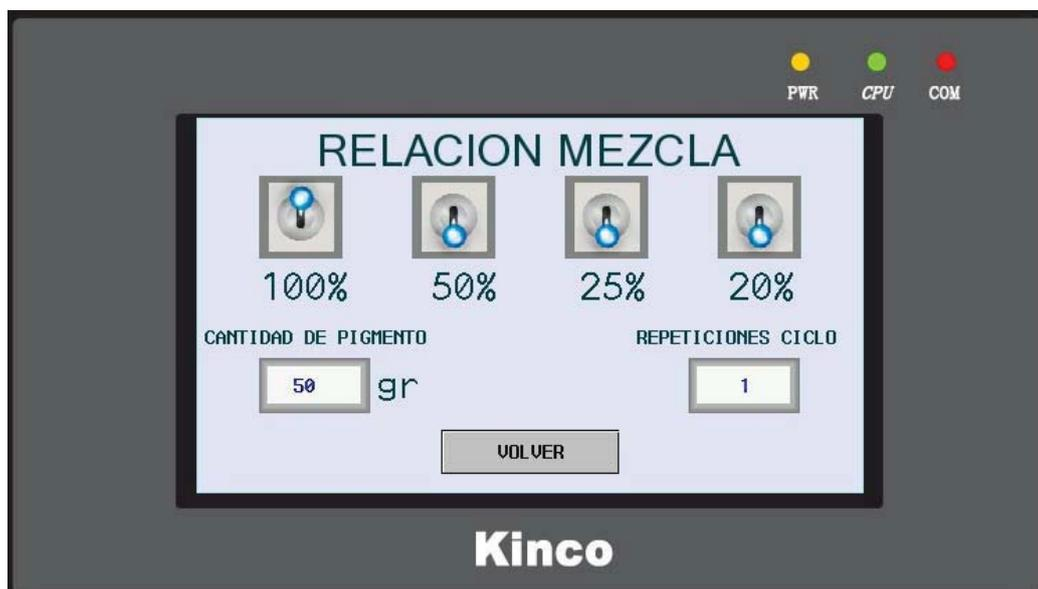
En esta pantalla se nos muestra los distintos porcentajes de mezcla que puede hacer el dosificador electrónico DOSIPAIN3010
