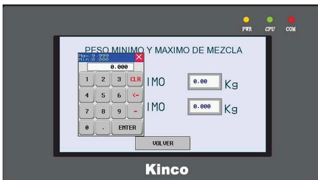
El peso mínimo sirve para indicar el mínimo de mezcla que tendremos en el calderín de mezcla y que el equipo de aplicación no aspire aire que nos producirá errores de abanico. Cada vez que trabajemos el peso será siempre superior al mínimo, la máquina se encargará de ello en el primer ciclo que realice al pulsar trabajo, cuando se iguale con el peso mínimo
