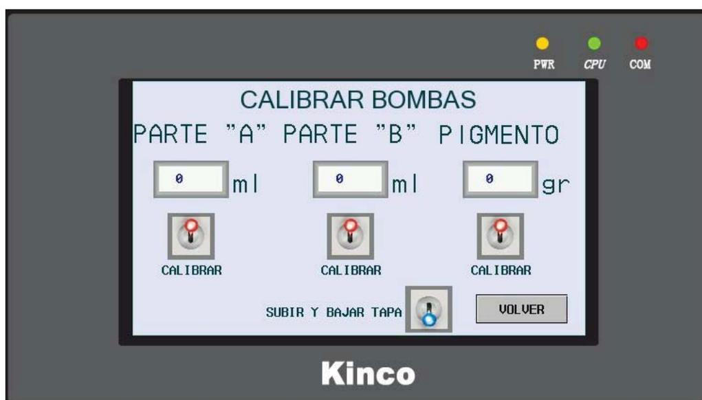
En esta pantalla se nos permite comprobar el volumen de producto que tira la bomba de **parte A** y el volumen de producto de la **parte B**.
