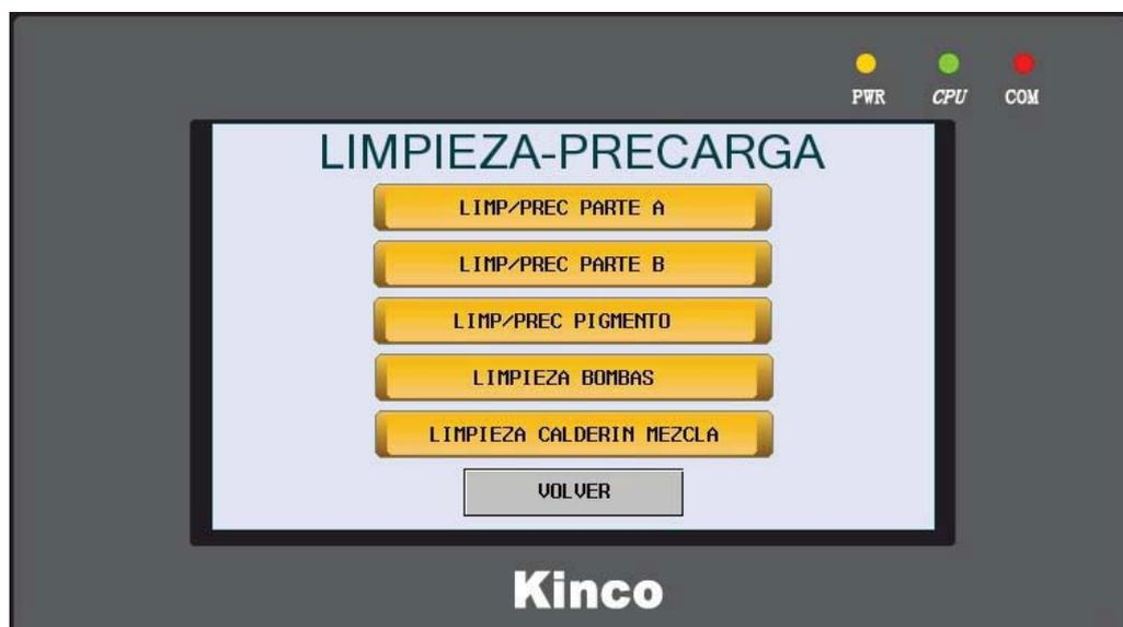
En esta pantalla podemos seleccionar la limpieza de los 3 componentes de la dosificadora, podemos seleccionar la limpieza de solo las bombas de producto de parte A y de parte B y podemos seleccionar la limpieza del calderín de mezcla. Dependiendo del tipo de limpieza que deseamos hacer, pulsaremos sobre una tecla de limpieza o otra.
