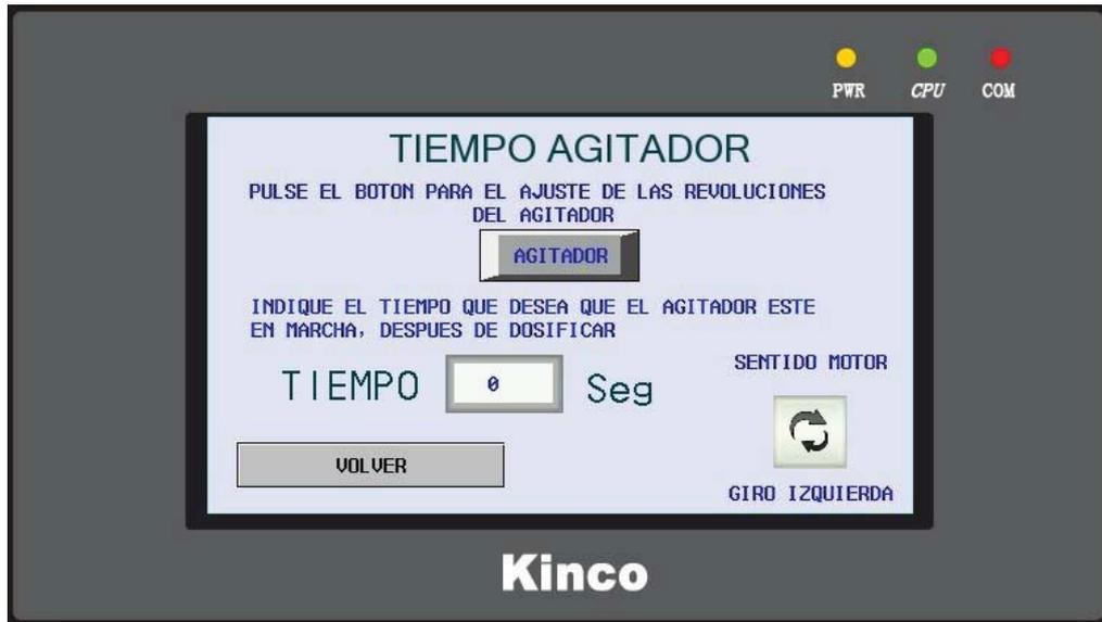
Aquí podemos ajustar la revoluciones del agitador, para ello pulsaremos sobre el botón de **AGITADOR** y empezara a girar el motor, ajustaremos las revoluciones del motor, de forma visual o con un contador digital de rpm, con el **regulador revoluciones agitador (7)** que se encuentra en el lateral derecho de la máquina.
