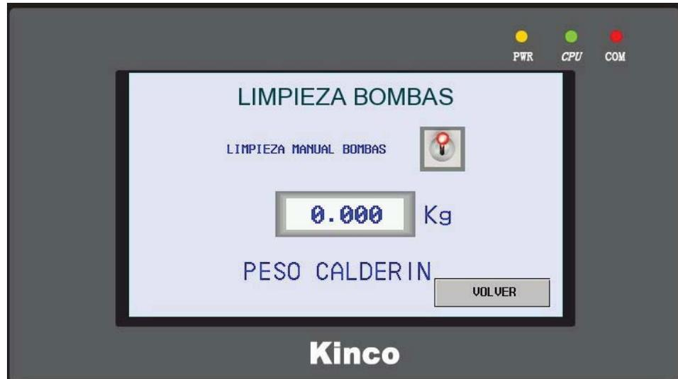
En esta pantalla podemos limpiar las dos bombas de producto simultáneamente y el circuito de producto mezclado hasta la pistola.
