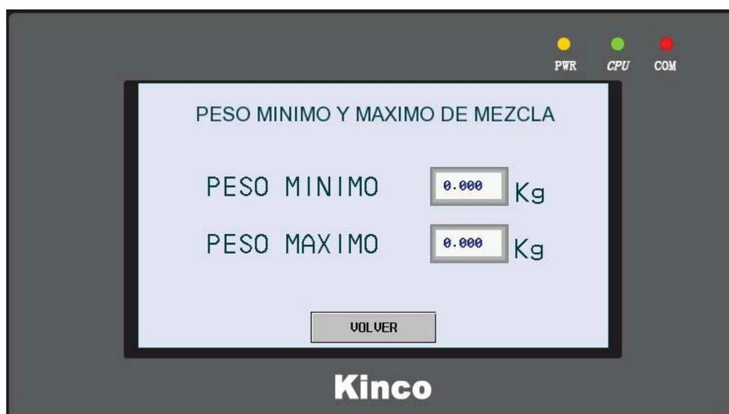
En esta pantalla se nos mostrará dos indicadores de peso en Kg, para indicar el peso mínimo de producto mezclado, pulsaremos sobre el indicador de peso y se nos mostrará un teclado numérico, con el que introducimos el peso deseado y luego pulsaremos ENTER. Si el peso está por debajo de 1kg deberemos escribir primero un (0), seguido de un punto (.) y después el resto de dígitos, así le indicamos los gramos que queremos.
