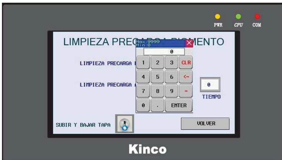
De esta forma se abrirá la válvula de pigmento el tiempo que le hemos indicado previamente, evitando consumo excesivo de disolvente.
