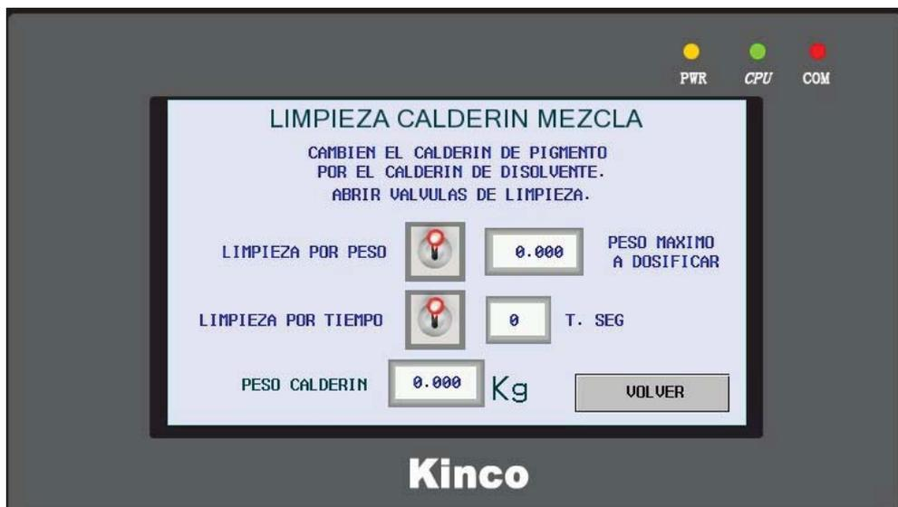
En esta pantalla primero se nos informa que soltemos la conexión del **calderín pigmento (D)** desde la **salida pigmento (25)** y la **alimentación aire calderín pigmento (26)**, y conectemos la conexión de **limpieza válvula pigmento (27)**.
