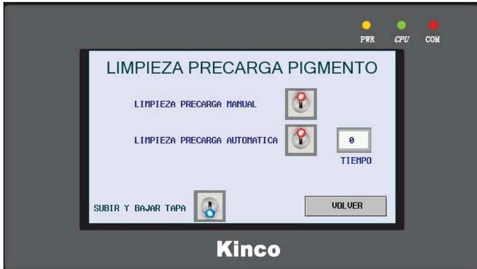
En esta pantalla podemos limpiar la válvula de pigmento de dos formas, de forma manual y de forma automática mediante una temporización.
