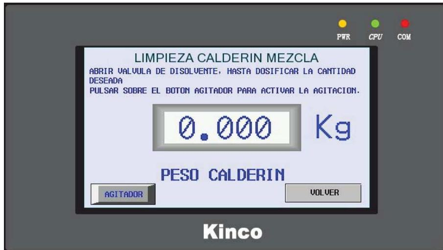
En esta pantalla se no indica que debemos de abrir la **válvula manual disolvente (21)** que se encuentra en la tapa del **calderín mezcla (C)** y que tiene una maneta roja.
