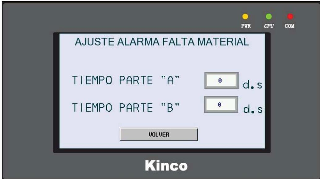
Aquí ajustamos el tiempo que tarda la bomba de la **parte A** y la bomba de la **parte B** en recorrer su carrera de arriba abajo.
