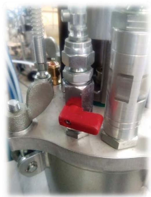
Si deseamos volver a repetir el proceso, solo hay que abrir de nuevo la válvula manual que se encuentra en la tapa del calderín de mezcla y hacer salir todo el disolvente de limpieza por la pistola de aplicar.
