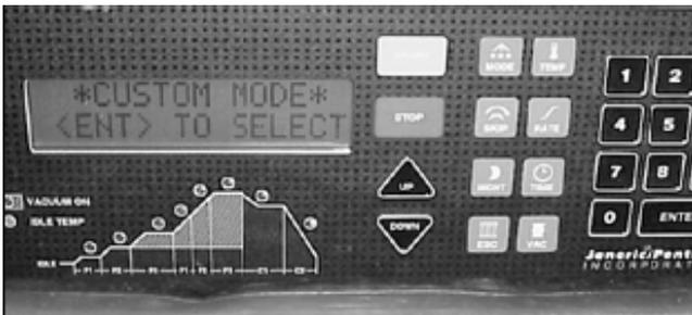
Figura 2B. Pulse “MODE” hasta que aparezca **CUSTOM MODE** en la pantalla.
