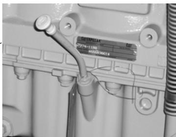
Varilla de medición de aceite del motor
