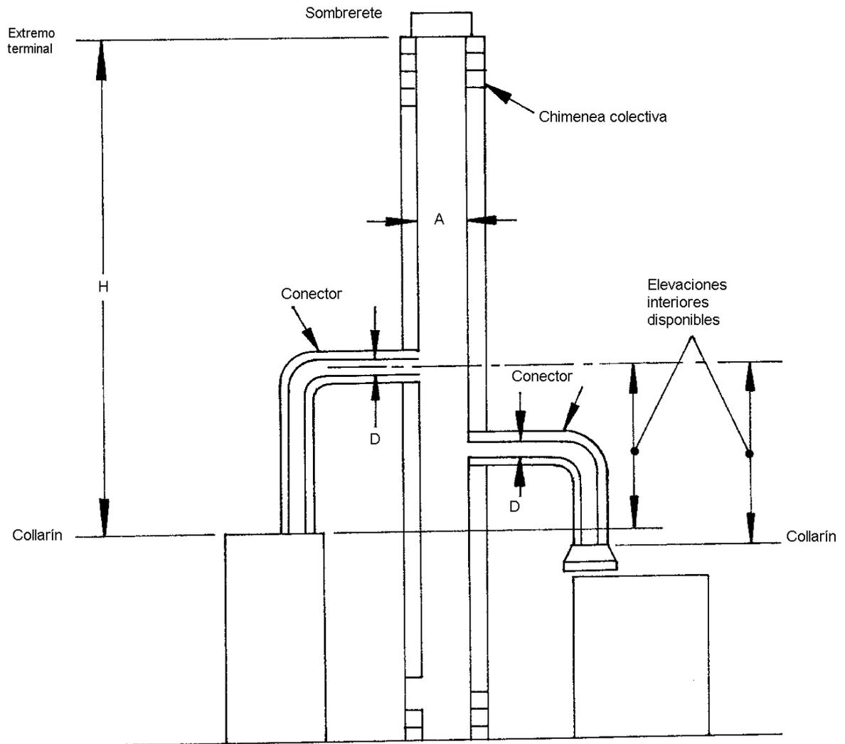
Figura A6. Las Tablas A6.1 y A6.2 se utilizan para las dimensiones de chimeneas de mampostería con conectores metálicos de pared sencilla, respectivamente, acoplados a dos o más artefactos de gas del Tipo B.1 que funcionan por tiro natural o del Tipo B.2 que operan por tiro mecánico inducido o de ambos
