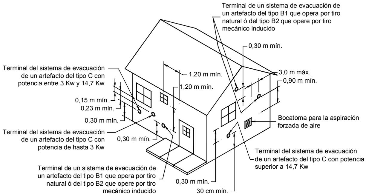
**Figura 8. Distancias que deben conservar los extremos terminales de los sistemas de evacuación para artefactos del Tipo B1 que operen por tiro natural, del Tipo B2 que operan por tiro mecánico inducido o del Tipo C que operan por flujo balanceado con respecto a ventanas, puertas y aberturas de ventilación**
