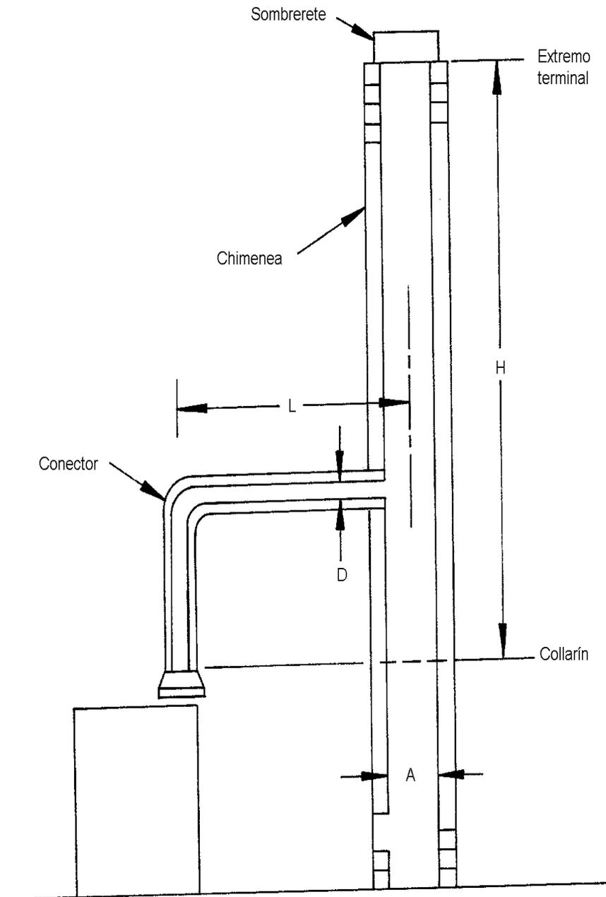
Figura A2. La Tabla A2 se utiliza para las dimensiones de chimeneas de mampostería con conectores metálicos de pared sencilla, acoplados a un solo artefacto de gas del Tipo B1 o del Tipo B2 que opere por tiro mecánico inducido
