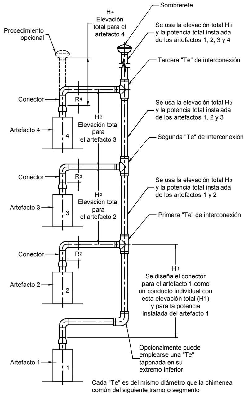
Figura 2. Sistema colectivo de evacuación a varios niveles
