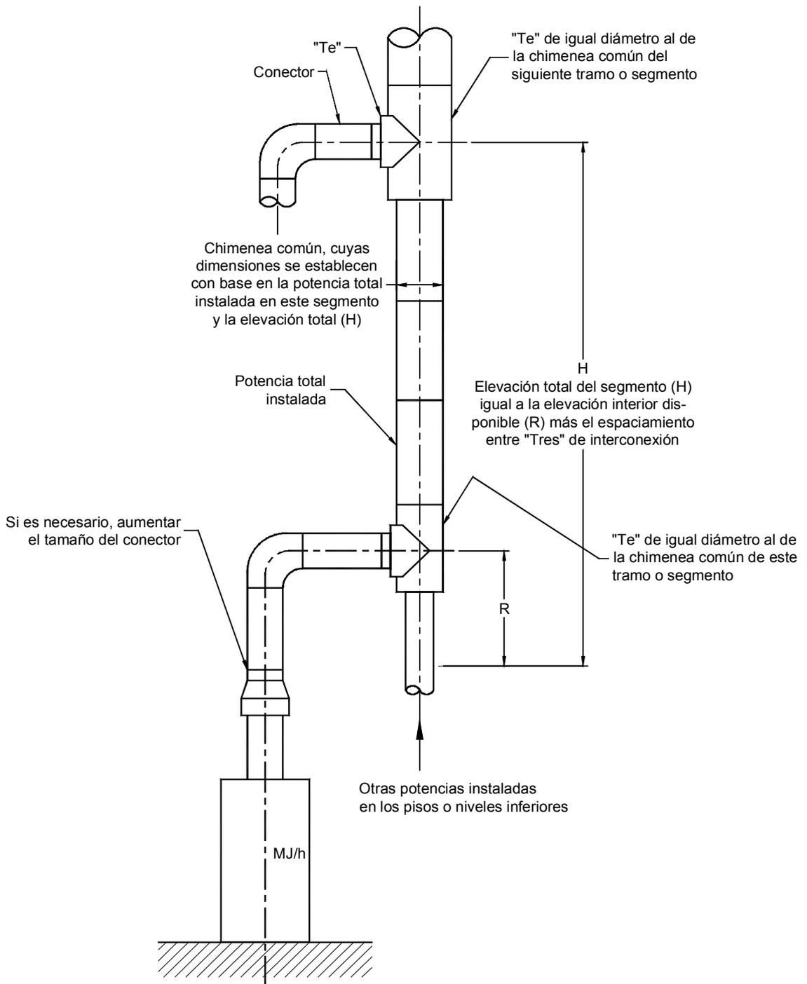
El tamaño del conector depende de: la potencia nominal en el tramo o segmento, la elevación inferior disponible (R), la elevación total del segmento (H).
