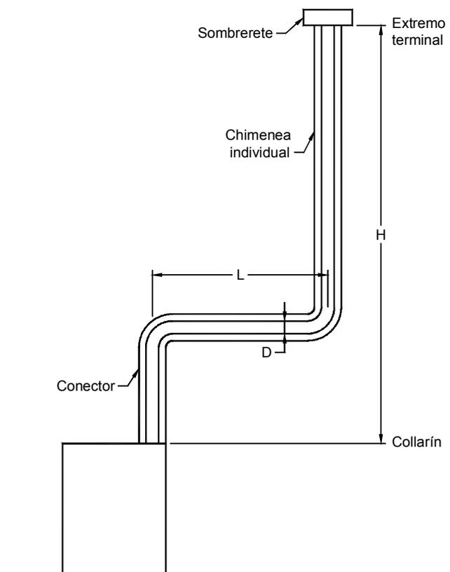
**Figura A1. La Tabla A1 se utiliza para dimensionar los accesorios, conectores y chimeneas, metálicos, de pared sencilla, acoplados a un solo artefacto de gas del Tipo B1 o del Tipo B2 que opere por tiro mecánico inducido**
