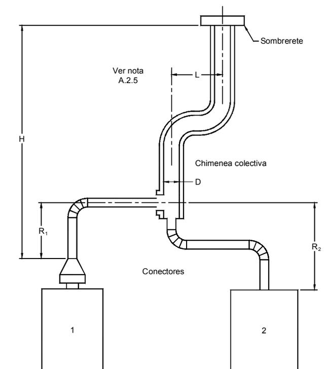
**Figura A7.** Las Tablas A.7.1 y A.7.2 se utilizan para las dimensiones de chimeneas y conectores, de cemento-asbesto, respectivamente, acoplados a dos o más artefactos de gas del Tipo B.1. Este ejemplo considera además dos cambios de dirección a 90 ° en la chimenea colectiva
