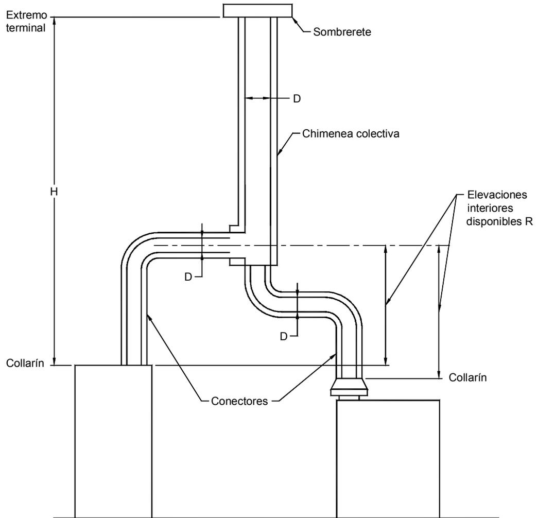
Figura A4. Las Tablas A5.2 y A5.1 se utilizan para las dimensiones de las chimeneas y conectores metálicos de pared sencilla, respectivamente, acoplados a dos o más artefactos de gas del Tipo B.1 que operen por tiro natural o del Tipo B.2 que operen por tiro mecánico inducido, o de ambos.
