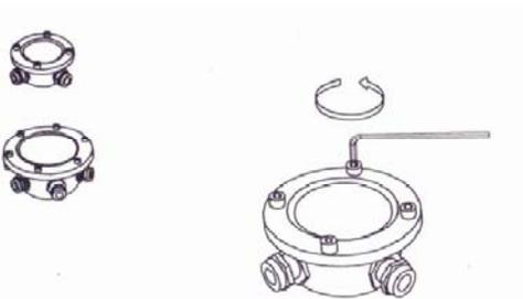
Introduzca los cables de las luminarias por los conectores, apriete las tuercas para que el sellado entre el empaque y el cable sea adecuado.
