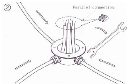
Vierta Resina Epoxica sobre la caja de conexiones para hacer totalmente hermética dicha conexión (Se puede usar cualquier tipo y marca de resina EPOXICA que exista en el mercado).
