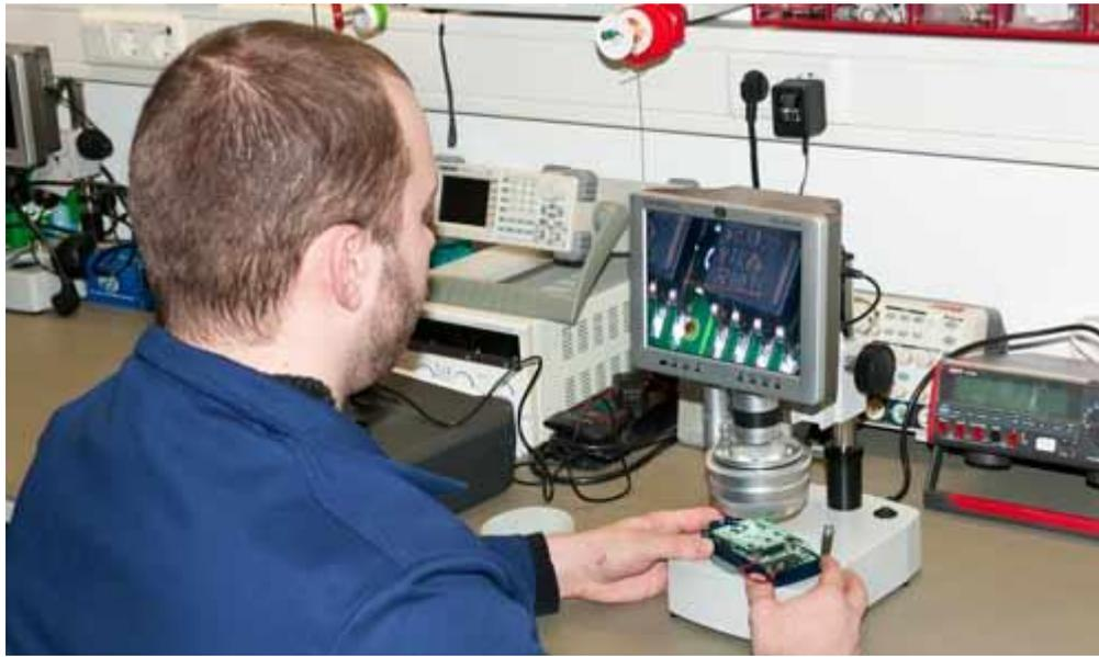
Aquí puede ver el microscopio motorizado 3D durante el análisis de un driver a través de la pantalla
