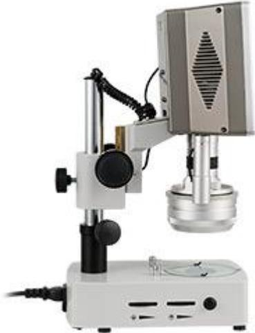
Vista lateral del microscopio motorizado 3D
