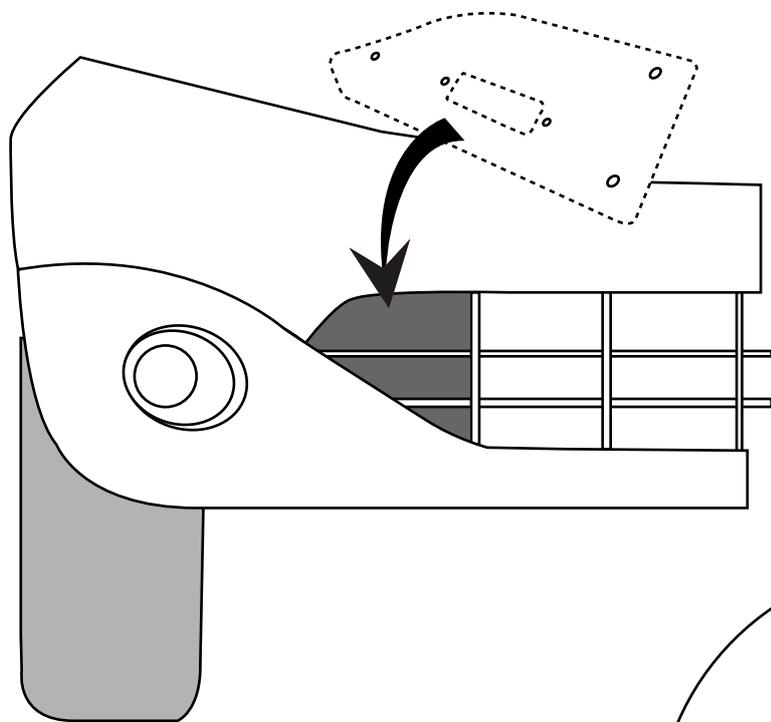
En primer lugar utiliza la plantilla “**pieza E**” para señalar el emplazamiento donde irá colocado el dispositivo LED
