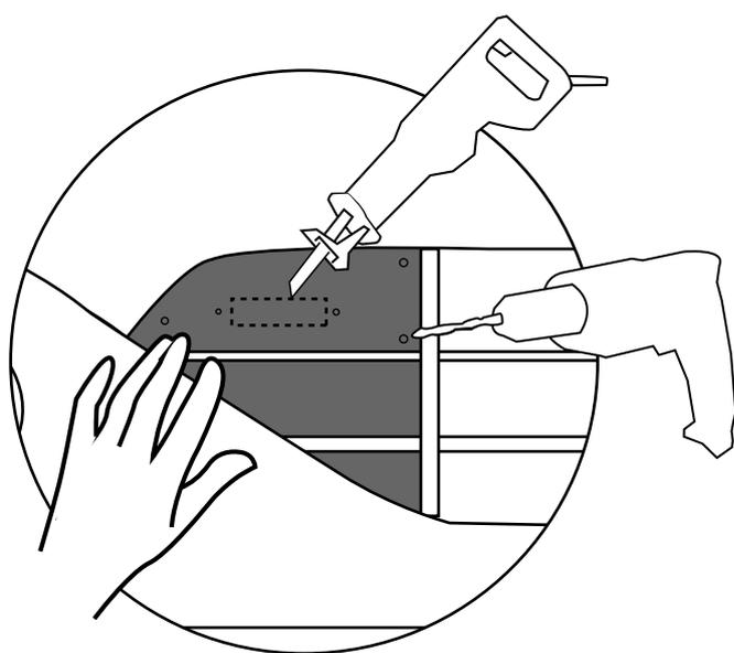
Realiza el corte siguiendo la línea que has pintado y los orificios para pasar los tornillos
