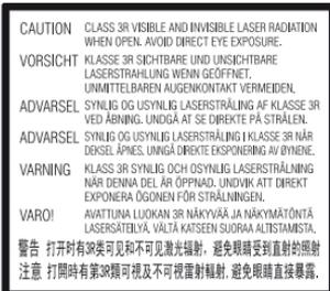
La unidad de lectura de este aparato está clasificada como un producto CLASS 3R LASER. Cuando se abre la carcasa protectora del láser, se emite radiación láser visible e invisible por lo que debe asegurarse de evitar la exposición directa a los ojos. Esta clasificación está ubicada en la carcasa protectora del láser dentro del recinto.
