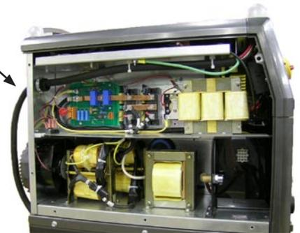
Retire completamente el cable interno del autotransformador conectado al conmutador conexión/desconexión de alimentación y al autotransformador. Conecte el cable de la fuente de alimentación proporcionada para el cliente al conmutador de conexión/desconexión de alimentación.
