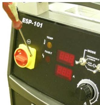
Para retirar el conmutador, separe primero la cubierta del conmutador mediante un destornillador tal y como se muestra en la imagen. Realice esta operación en ambos lados del conmutador para acceder a los tornillos del conmutador que quedan debajo de la cubierta.
