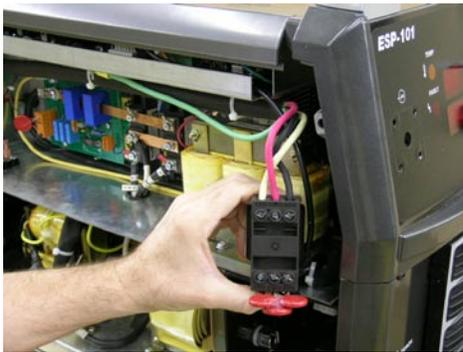
Tire del conmutador desde la parte tarde del panel y rótelo para acceder a las conexiones de cables.
