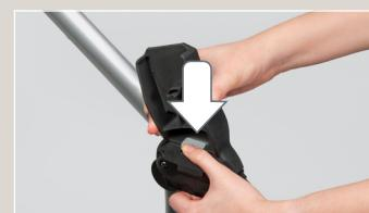
**POUR RETIRER :** Appuyez sur le bouton de dégagement, au dos de l'adaptateur, et tirez celui-ci vers le haut pour le dégager du châssis de la poussette.
