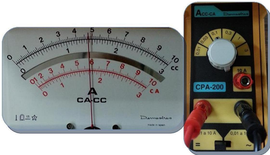
Figura N° 2. Escalas del amperímetro analógico Demestres CPA-200.
