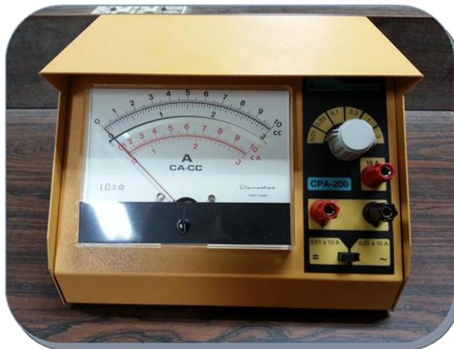
Figura N° 1. Amperímetro analógico Demestres CPA-200.
