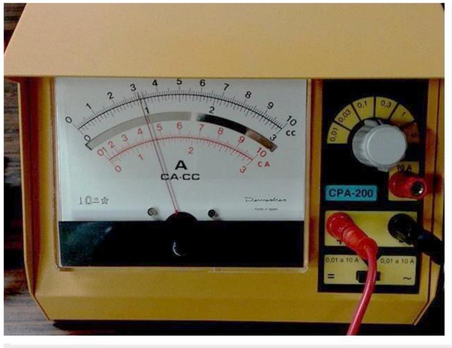
Figura N° 3. Amperímetro analógico Demestres CPA-200 con puntas de prueba.
