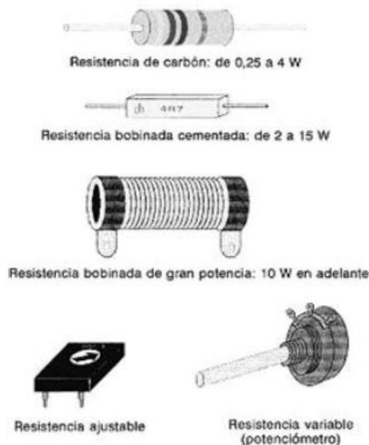
Figura N°8: Tipos de Resistencias.
