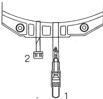
1. Quitar el tapón protector del conector (1) del tubo de conexión.
