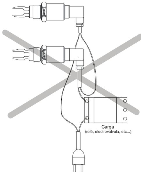
tensión de desenganche del relé es mayor que la tensión en la bobina del relé para una corriente de 6 mA. Si no es así, es posible que el relé quede activado independientemente del estado de salida del LD61.
