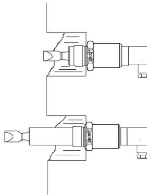
De la misma forma, cuando el detector es instalado en una zona donde hay caudal, debe tenerse en cuenta su posición. Se instalará siempre de modo que las aletas queden paralelas a la dirección del caudal.
