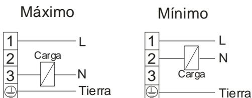
El modo de funcionamiento (máximo o mínimo) viene dado según el conexionado, tal como indica la figura siguiente.
