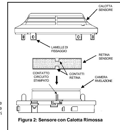
Figura 2: Sensore con Calotta Rimossa
