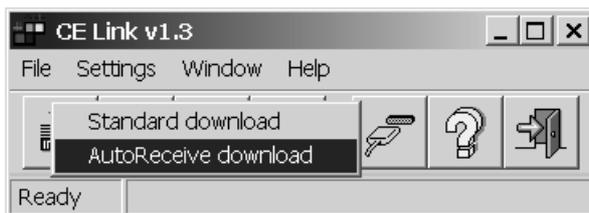
**Fig. 67. Ventana de descarga de recepción automática**
