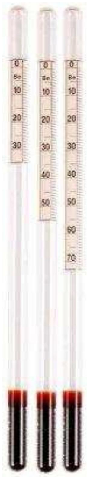
**Areómetro en grados Baumé - SALINOMETRO
