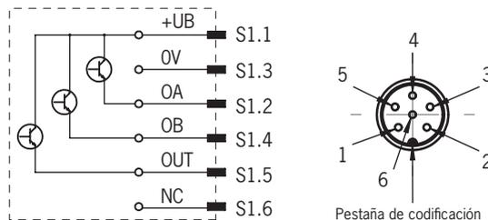
Vista del lado de la conexión del interruptor de seguridad
