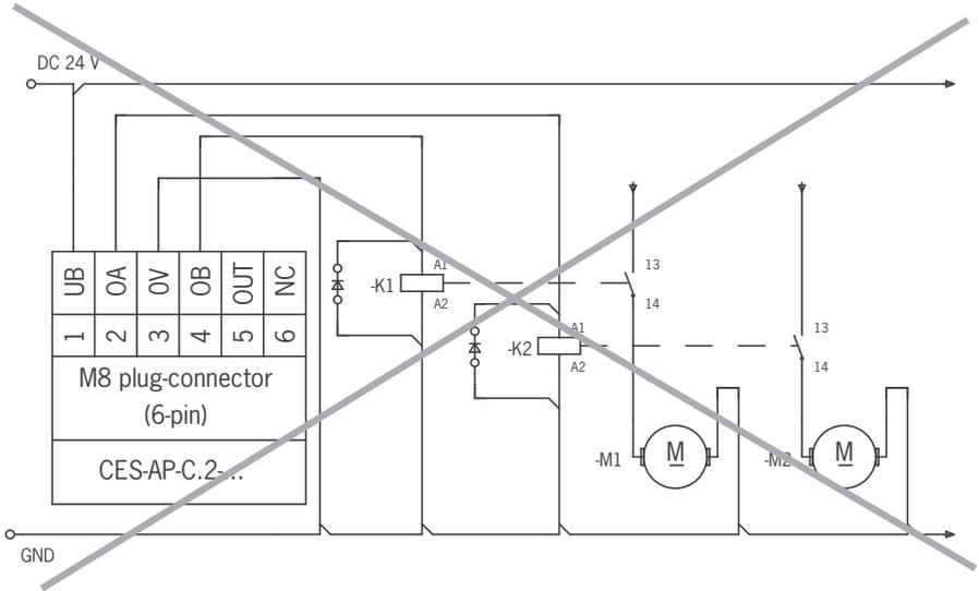
Figura 4: Ejemplo de conexión errónea
