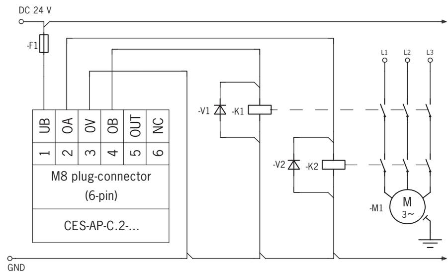
Figura 3: Ejemplo de conexión CES-AP-CR2-CH/CES-AP-CL2-CH
