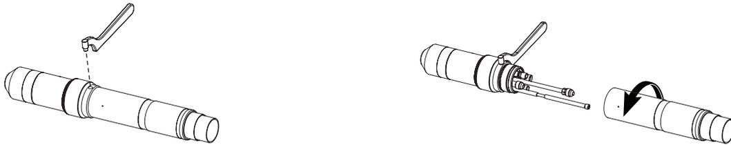
3. Empuje hacia atrás la cubierta trenzada y deslice la manga sobre las mangueras. Alinee la antorcha con las mangueras en el conjunto de cables y mangueras. Se las ha unido con cinta adhesiva para prevenir que se retuerzan.
