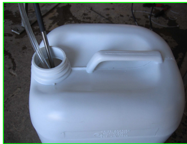
Sonda de nivel y tubería de aspiración introducidas en la garrafa de producto.
