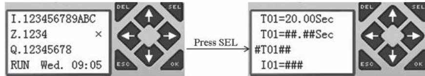
1b. Estado funcionamiento HMI: La HMI se habilita en base a la condición del programa usuario (memoria M02).
