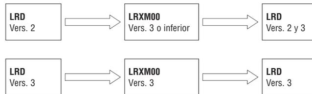
La memoria de backup LRXM00 Vers. 3 se conecta en la misma entrada del cable de programación (véase el procedimiento siguiente).
