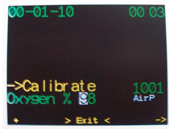
Si las células muestran los mismos valores dentro de siguientes 10 segundos y se encuentran dentro del mismo rango de trabajo, las células serán calibradas de forma automática. De lo contrario, la célula (células) se desconectará.-**OFF** mode
