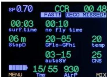
En la parte inferior de la pantalla están el indicador de la batería, gas actual y la presión atmosférica.
