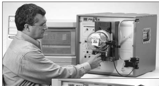
En adaptador universal de Base-A se puede instalar fácilmente en PHAZER modelo J120 para facilitar realizar las pruebas de los medidores Base-A.
