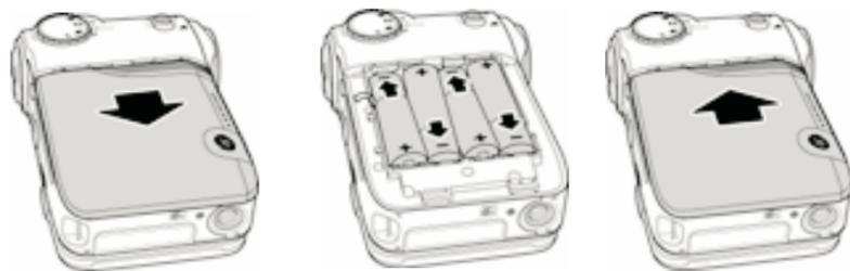
Tenga en cuenta la polaridad de las pilas. Preste atención a que los polos positivos (+) y negativos (-) estén colocados correctamente para evitar cortocircuitos.
