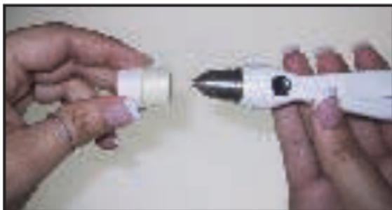
Faites glisser le couvre-pointe Ocu-Film® + sur la pointe du Tono-Pen en vous assurant que le caoutchouc est à plat sur la pointe, sans être tendu.
