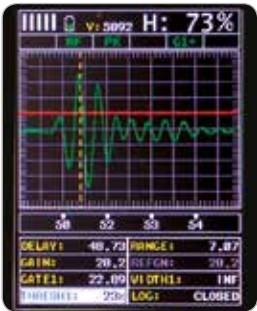
MODO DE FALLAS Modo Básico de Fallas Demostración básica de detección de fallas usando un elemento sencillo de de transductores de ángulo de emisión disponibles en CG100ABDL y CG100ABDL+ medidores de espesor de corrosión.
