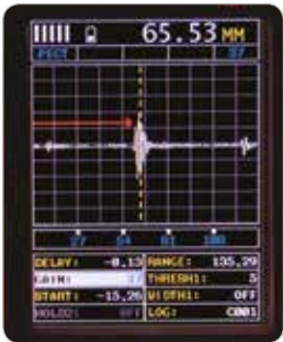
PECT Modo de Pulso a Eco Revestimiento Muestra ambos el espesor del material (PE) y el espesor del revestimiento (CT) al mismo tiempo.
