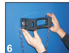
4.7 Botella de gas se pone delante de la armadura y se asegurar con la cadena.
