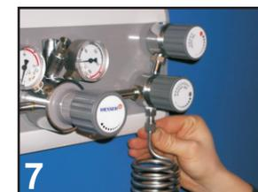
4.9 ▲ Si se utiliza gases corosivos, toxicós hay que precurar, que no haiga peligro. Por eso hay que montar la presión reguladora y válvula dosificadora (imagen 8), con los tubos de conexión, se montan con teurcas de racor 1¼ vuelta para asegurar.
