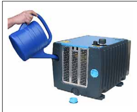
Fig. 7: Rellenar separador de líquidos tipos 2BL2 041 - 141 (a través de la abertura de llenado)
