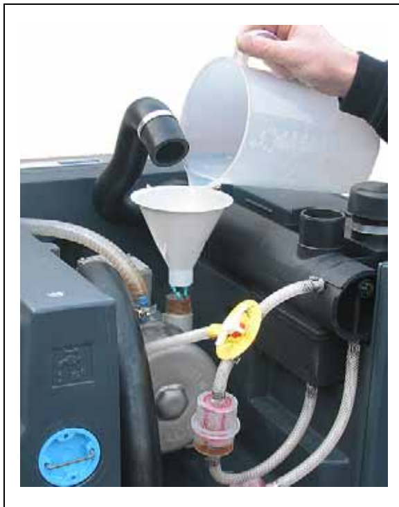
Fig. 13: Rellenar antioxidante / líquido desincrustante al grupo incorporado (para los tipos 2BL2 041 - 2BL2 141)
