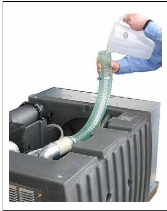
Fig. 14: Rellenar antioxidante / líquido desincrustante al grupo incorporado (para los tipos 2BL2 251 - 2BL2 341)
