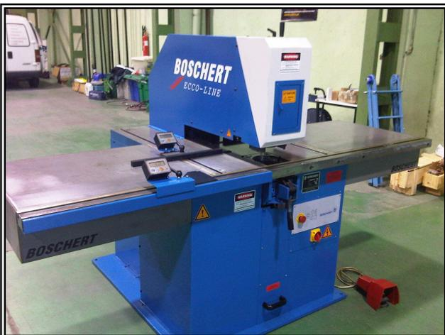
**PUNZONADORA MANUAL** del año 1998 modelo **ECO-LINE EL 500** . Máquina de estructura robusta, cambio rápido del punzón y de la matriz, carrera regulable entre punzón y matriz, sistema de cambio rápido de utillaje tipo Trumpf y con lector Digital para los ejes X e Y e Utillaje.
