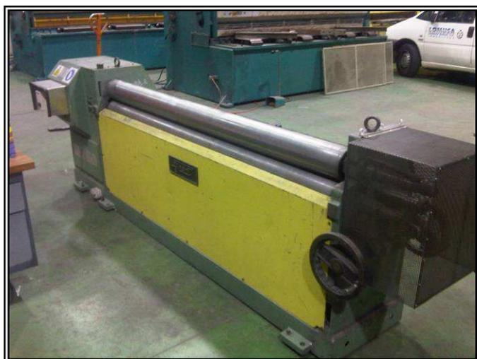
CILINDRO EPART del año 1991 modelo 10B de longitud 2000 mm para espesor max. 3 mm y prolongación en las rulinas para el curvado de perfiles.
