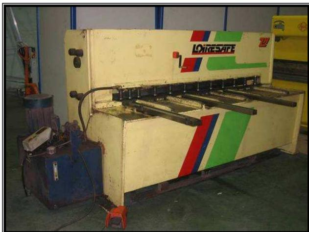
**CIZALLA "LOIRE" mod. CHV-42 de 2000 x 4 mm.** en acero suave 45Kg/mm<sup>2</sup> de corte vertical del año 1990, 1,5° de ángulo de corte (fijo), 5,5 Kw de potencia. Máquina sin cuello de cisne y con tope con accionamiento manual con contador mecánico y con curso de 530 mm
