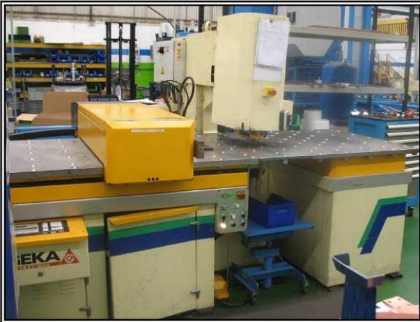
**CIZALLA PUNZONADORA “GEKA” mod. Puma 80** del año 1999 con escote de 750 mm, Paxi CNC 1500 del año 2001 y cabezal tripe de Punzonado y utillaje.
