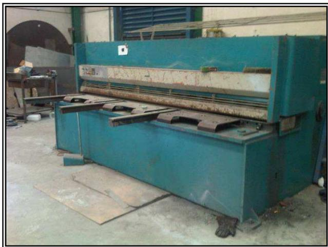
**CIZALLA "ADIRA" mod. GHS-0630 del año 2004 de 3080x 6,5 mm.,** con tope posterior gobernado por un Posicionador Electrónico ADIRAMATIC 2011, Un brazo de apoyo frontal de 1100 mm de longitud con escala graduada y dos guías y dos brazos de apoyo simple de 1100 mm de longitud y sobremesa con esferas transportadoras.
