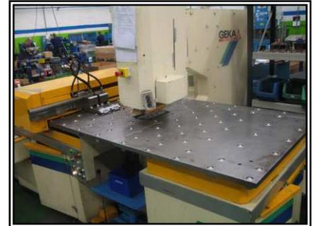
**PUNZONADORA** del año 2000 marca **TRUMPF** mod. **TRUMATIC 2000 ROTACIÓN** con 20 Tm/180 kN, con area de trabajo de 1270 x 1270 mm, con control numérico, cabezal de punzono hidráulico con eje giratorio ,con mesa de cepillos ampliada a 4000 mm y con utillaje.
