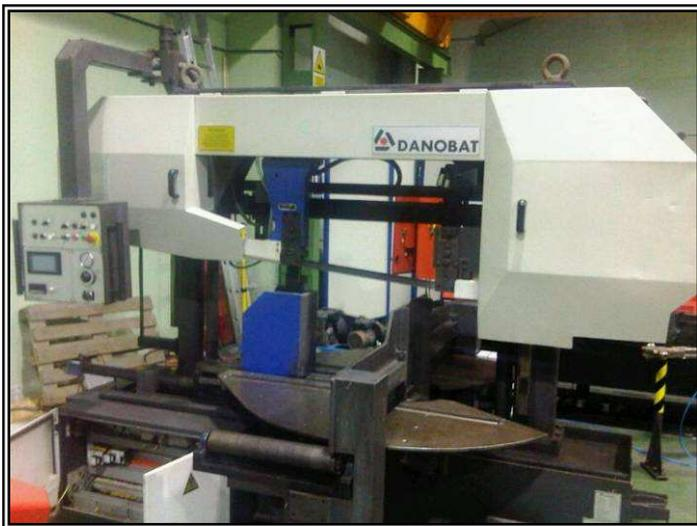
**Sierra de cinta "DANOBAT" del año 2006 modelo CPI 70/50DI** de doble columna con giro CNC a  $-60^\circ$  o  $+45^\circ -60^\circ$  con panel de mandos aéreo giratorio, tensado automático, lámpara de posicionado, apriete vertical hidráulico, mordaza y brazo solidario, refrigeración aire-aceite, mordazas de gran capacidad, regulación presión mordazas y rodillos en la mesa.
