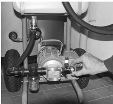
1. Conectar la manguera de presión con la salida de la bomba
