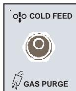
Para activar la Alimentación en Frío, mantenga el interruptor en la posición **ARRIBA (UP)**. El mecanismo de alimentación alimentará al electrodo pero ni la fuente de poder ni el solenoide de gas estarán energizados. Ajuste la velocidad de la alimentación en frío girando la perilla WFS. Alimentar o "desplazar" el electrodo en frío es útil para pasar el electrodo a través de la pistola.
