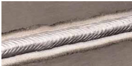
La frecuencia de pulsación es ajustable. Cambiar la modulación de frecuencia (o control del arco) de la forma de onda cambia el espaciamiento del rizado. Es posible lograr velocidades de recorrido más rápidas utilizando valores mayores de modulación de frecuencia.
