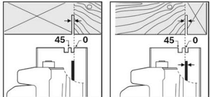
A marcação de corte de 0° (10) indica a posição da lâmina de serra para cortes perpendiculares. A marcação de corte de 45° (9) indica a posição da lâmina de corte para cortes de 45°.
