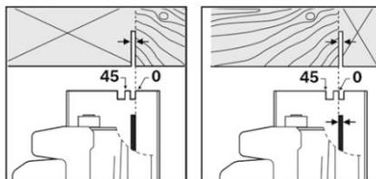
Le marquage de coupe 0° (10) indique la position de la lame de scie lors d'une coupe à angle droit. Le marquage de coupe 45° (9) indique la position de la lame de scie lors d'une coupe à 45°.
