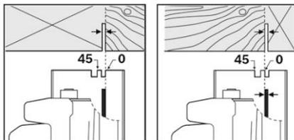
Die Schnittmarkierung 0° (10) zeigt die Position des Sägeblattes bei rechtwinkligem Schnitt. Die Schnittmarkierung 45° (9) zeigt die Position des Sägeblattes bei 45°-Schnitt.
