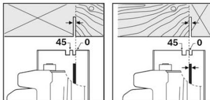
La marca de posición 0° (10) indica la posición de la hoja de sierra al efectuar cortes perpendiculares. La marca de posición 45° (9) indica la posición de la hoja de sierra al efectuar cortes a 45°.
