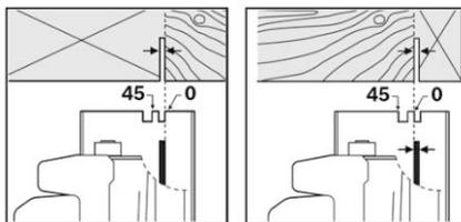
La marcatura del taglio 0° (10) indica la posizione della lama di taglio in caso di taglio ad angolo retto. La marcatura del taglio 45° (9) indica la posizione della lama di taglio in caso di taglio ad angolo retto da 45°.
