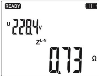
Leer el resultado principal de la medición: la impedancia en el bucle de cortocircuito  $Z_S$  y la tensión en el momento de la medición.
