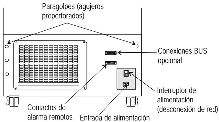
**Figura 1-2.** Componentes de la vista trasera del congelador
