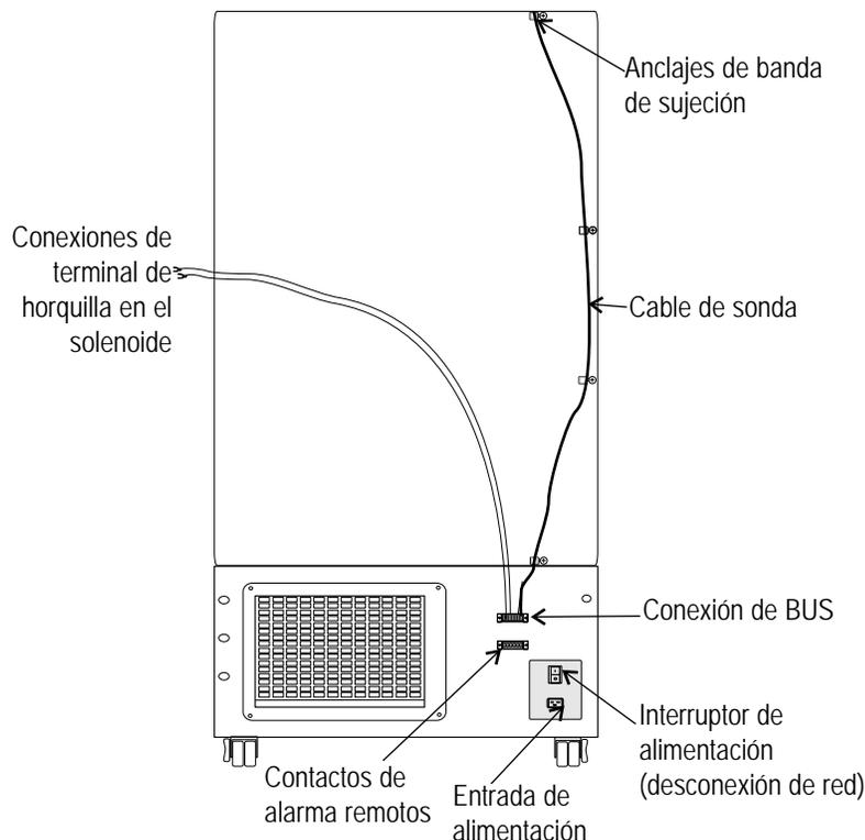
**Figura 5-5.** Cable de sonda con conexiones de solenoide
