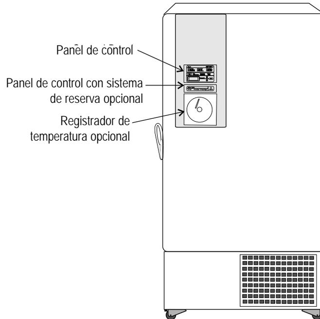
**Figura 1-1.** Componentes de la vista frontal del congelador
