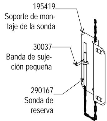
**Figura 5-3.** Sonda segura
