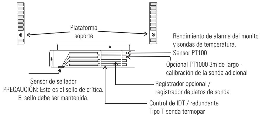
**Figura 1-3.** Sonda o sondas de la cámara
