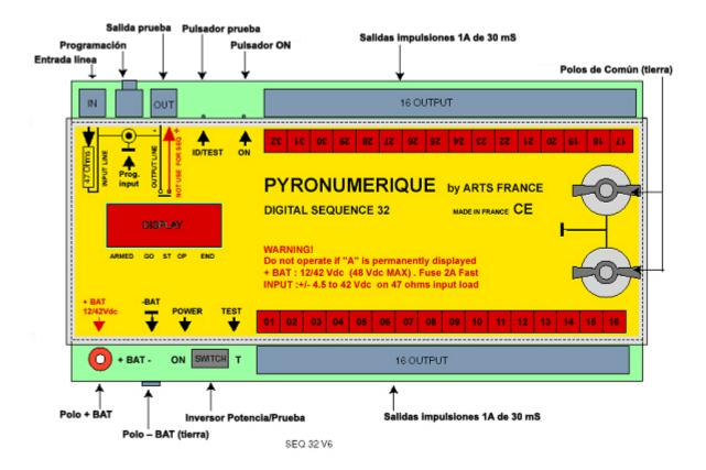
Por motivos de seguridad, este módulo no dispone de interruptor principal. La desconexión física del cordón de alimentación + Bat a nivel del bloque batería asume esta función.
