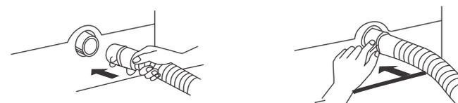
Lo ideal es dirigir permanentemente la desembocadura de la manguera de desagüe a algún desagüe cercano, lo que evitará que dicha manguera deba conectarse cada vez que se vaya a usar la lavadora. Si el desagüe está alejado de la lavadora, se podría solucionar el problema conectando la punta de la manguera de desagüe con otra manguera similar.
