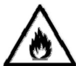
**Atención:** Este frigorífico contiene isobutano (R600a), gas refrigerante sin CFC pero combustible. Durante el transporte, instalación, limpieza y reparación del frigorífico se debe prestar atención a fin de no dañar partes del circuito de refrigeración, lo que provocaría pérdidas de gas. En caso de daño evitar el uso de llamas libres y ventilar adecuadamente el local en que se encuentra el frigorífico.
