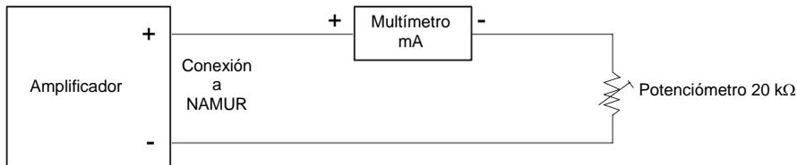
Con el potenciómetro se modifica la corriente del amplificador NAMUR. El punto de conmutación debe ser entre 1,2 mA y 2,1 mA. Es decir, con la corriente por debajo de 1,2 mA el relé de salida debe tener un estado y por encima de 2,1 mA el relé debe tener el otro estado.
