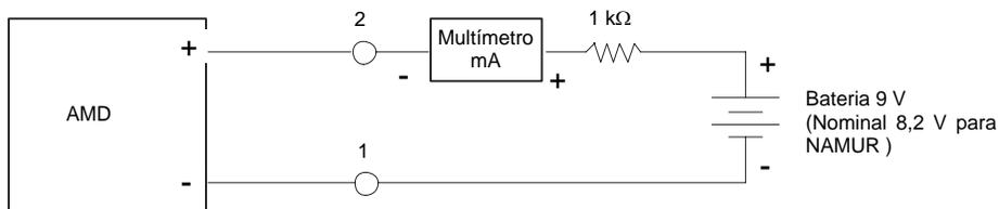
Si no se dispone del detector, se puede verificar el funcionamiento del amplificador aplicando el esquema de la página siguiente.
