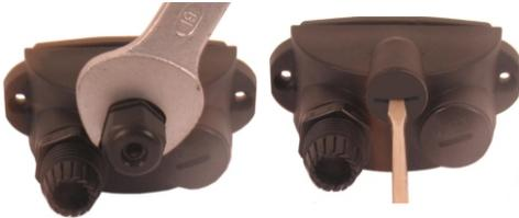
10.1 - Retire el racor atornillado nº 3 con la ayuda de una llave hexagonal de 19 mm.
