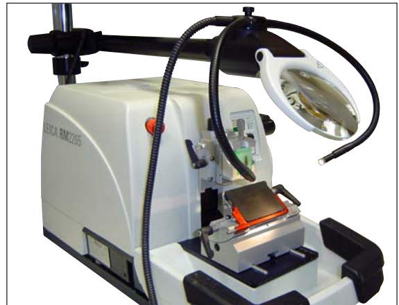
Fig. 62, microtomo de rotación con accesorios opcionales incorporados: lupa y conductor de luz de fibra óptica
