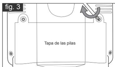
**Nota:** Cuando el indicador de encendido de la emisora comience a parpadear, sustituya las pilas conforme al procedimiento mencionado anteriormente.
