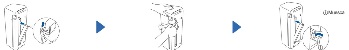
Desactive la máquina y guarde el panel de operación. Mientras presiona la lengüeta de la parte inferior de la máquina, tire de la tapa.
