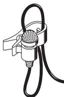
Fije el micrófono ME 2 mediante la pinza en la ropa, p.ej. en la solapa de la chaqueta. Tienda el cable de tal modo que no se produzcan ruidos por fricción en la ropa y no se crucen el cable del micrófono y la antena. El micrófono tiene una característica esférica. No es necesario darle una orientación exacta, pero debería fijarlo lo más cerca posible de la fuente acústica.
