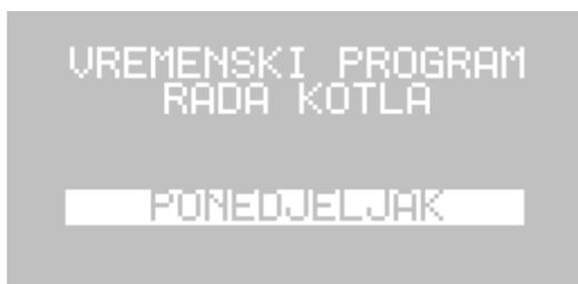
Se muestran cuatro periodos con respectivas fases de marcha y parada. En el ejemplo mostrado arranca la caldera a las 06:00 de la mañana y se para a las 16:00. Tras una pausa arranca de nuevo a las 19:00 y para a las 23:00. Entonces se mantiene apagada hasta día siguiente. Estos periodos de arranque y parada pueden ser fijados individualmente para cualquier día de la semana.
